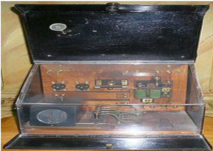
Судовая радиоприемная станция А. С. Попова образца 1901 г. для приема на ленту и на слух. Такими приёмными станциями были оборудованы многие корабли Черноморского флота
